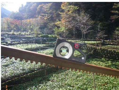
図 3-3 レール勾配の調査
