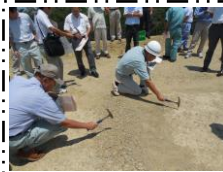
固結部と未固結部の強度比較
