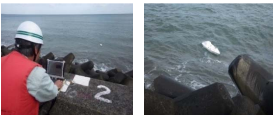
写真 4,5 調査用リモコンボート観測風景
