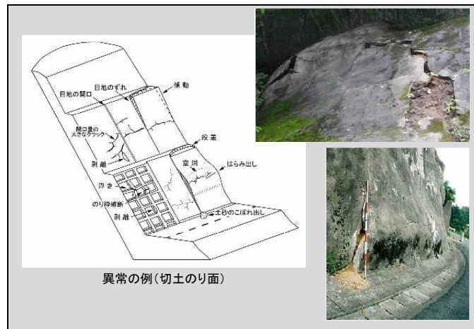
図-14 切土のり面の異常の例
