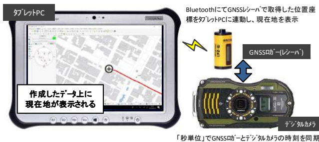
図6 現地調査で用いた機材
