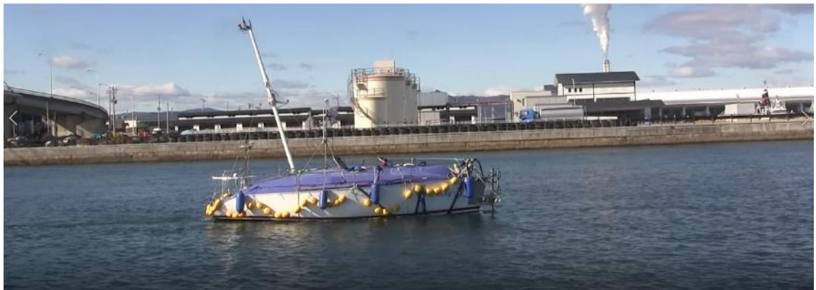
図 10. 松川浦航路を計測中の無人船（Windy-3S）
