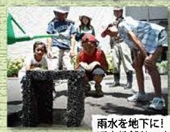
雨水を地下に！透水性舗装の実験
